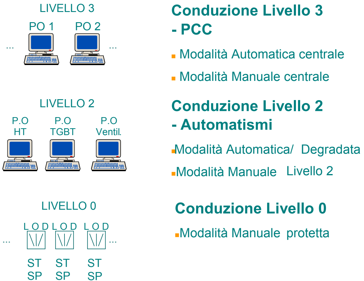
Figura 6 – Metodi di condotta delle installazioni elettromeccaniche
