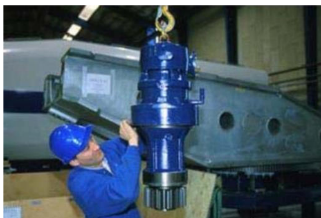
Figura 6 - Motori e riduttori di giri
