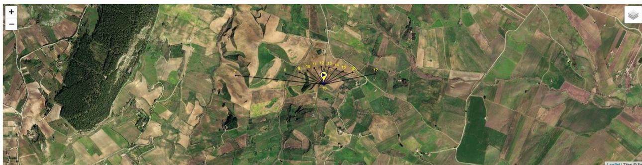
**Fig.3.14 - Proiezione ombra CAN\_04 (21.04 - equinozio di primavera)**
