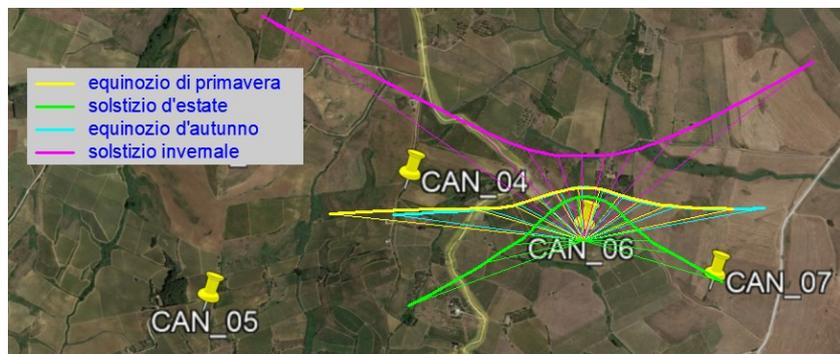
Fig.3.58 - Sovrapposizione ombre aerogeneratore 06
