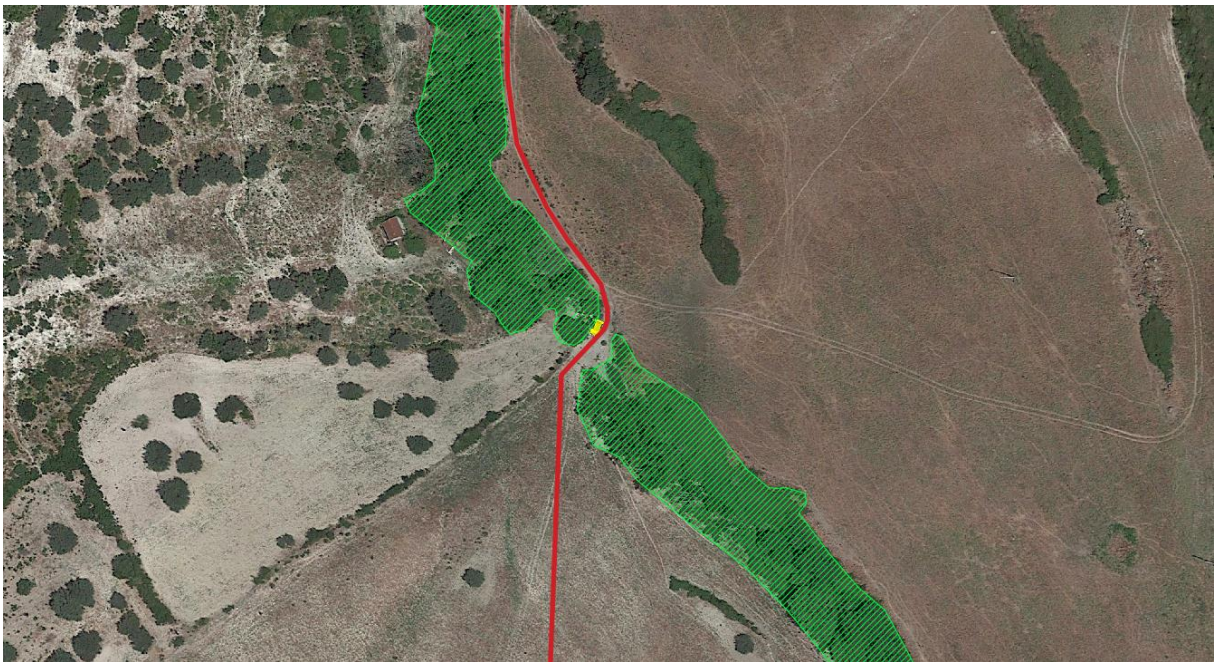
Figura 70: Dettaglio interferenza 1 con area boscata. In tale punto sarà prevista una TOC (A-A') in quanto il punto di intersezione con l'area boscata corrisponde anche ad un corso d'acqua tutelato ai sensi del DLgs 42/2004. Come evidente dall'immagine il punto di attraversamento non incide realmente sulla vegetazione e pertanto non insiste una reale interferenza con area boscata.
