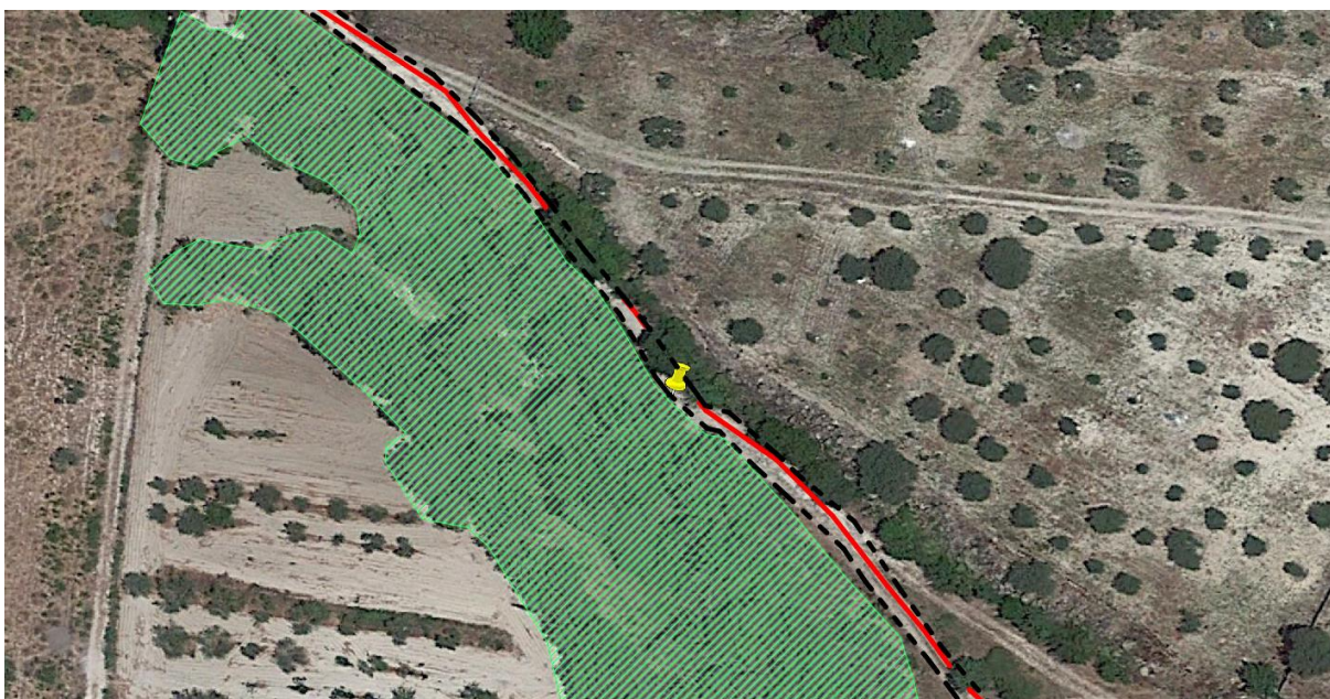
Figura 73 :Dettaglio interferenza 4 con area boscata. Come evidente dall'immagine il punto di attraversamento non incide realmente sulla vegetazione che risulta interrotta dalla presenza di una strada esistente asfaltata e pertanto non insiste una reale interferenza con area boscata.
