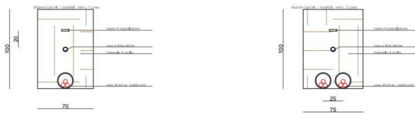
Fig. 8: Sezione tipo cavidotto AT/MT.
