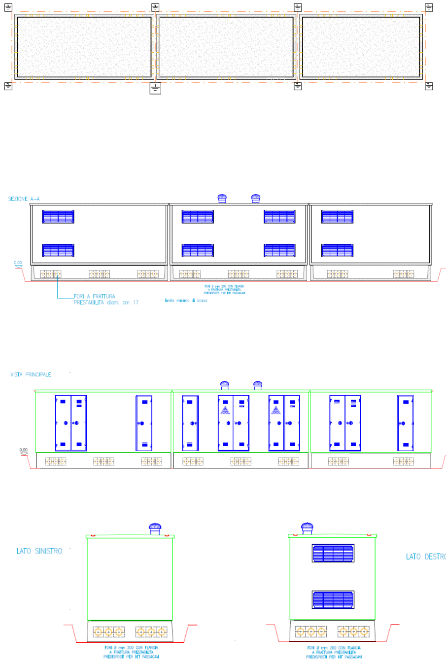
Figura 1: Cabine di trasformazione
