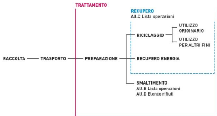
Figura 3 – Le fasi di gestione dei rifiuti generati da moduli fotovoltaici a fine vita (D.Lgs. 49/2014)
