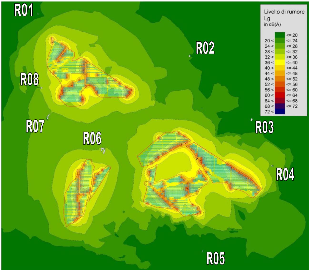
Figura 2. Modellazione scenario post operam – restituzione livelli al continuo quota 4 m [dB(A)]
