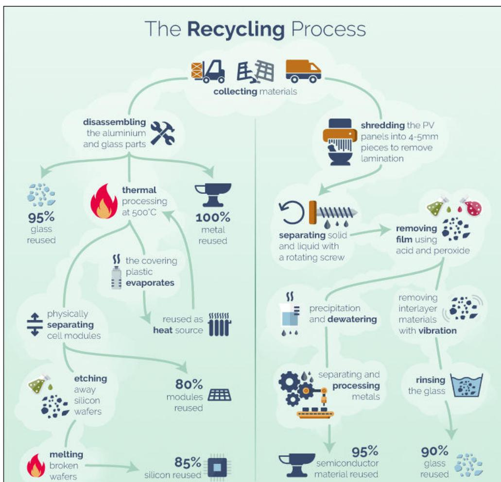
**Figura 62.** Il processo di riciclo dei moduli fotovoltaici a base silicea e dei sottoprodotti della dismissione di impianti fotovoltaici. Fonte: [www.greenmatch.co.uk/blog/2017/10/the-opportunities-of-solar-panel-recycling](http://www.greenmatch.co.uk/blog/2017/10/the-opportunities-of-solar-panel-recycling) (Ultimo aggiornamento: marzo 2021).
