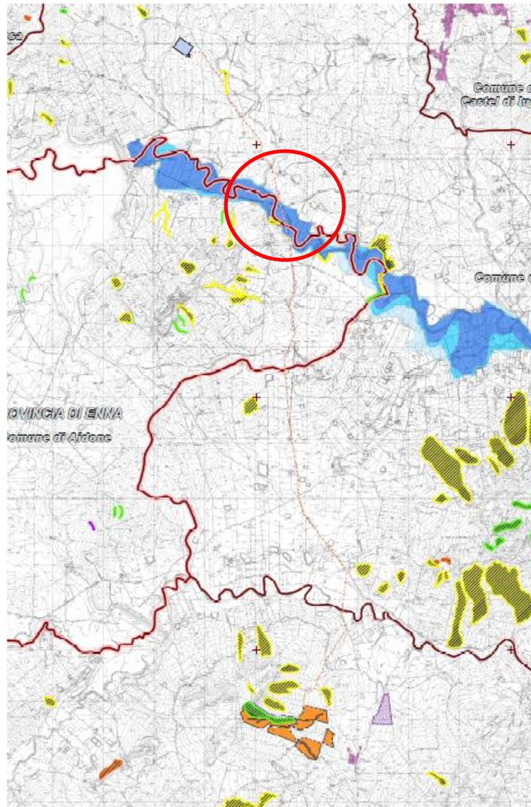
**Figura 13: Inquadramento dell'area di progetto rispetto al Piano di Assetto Idrogeologico- L'unica interferenza riguarda il tracciato del cavidotto e verrà risolta tramite Trivellazione Orizzontale Controllata**
