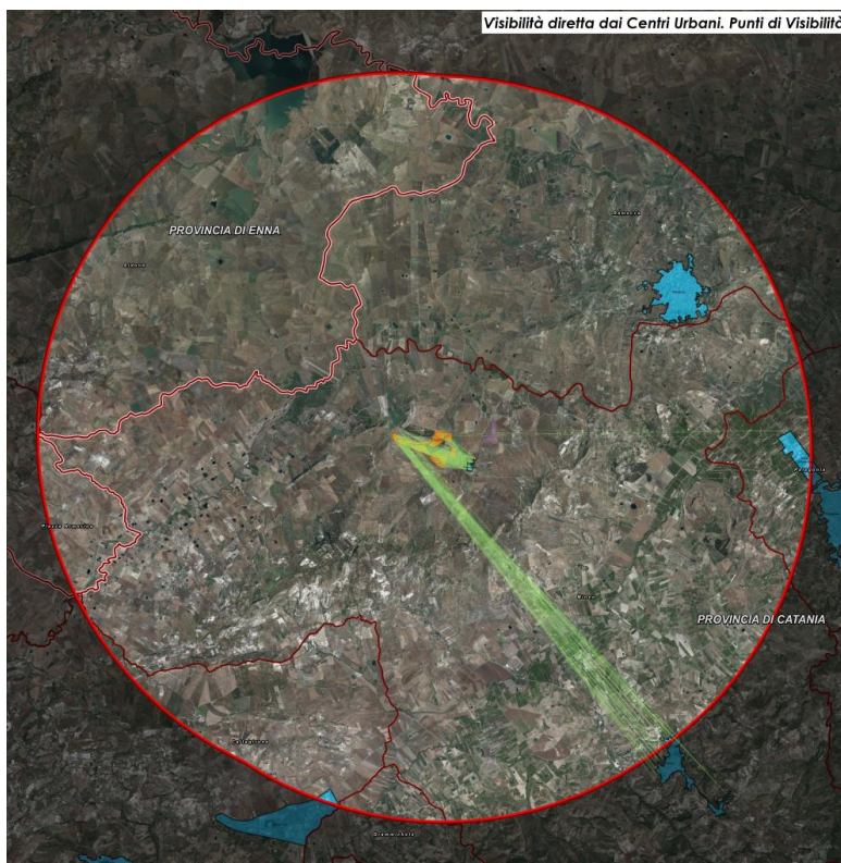
Figura 64: Mappa della visibilità diretta dal perimetro dei centri urbani. Punti di visibilità. In verde i raggi dei punti ripetuto ai quali saranno visibili alcune porzioni di impianto.
