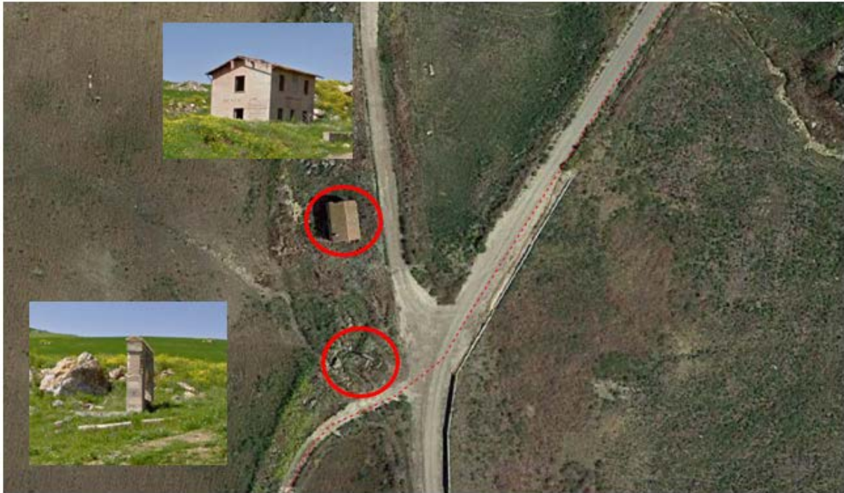
Figura 87: all'incrocio fra la SP 179 e la SP 182 sono collocati due beni censiti come beni isolati e in particolare 3. Abbeveratoio collocato a circa 10 metri dalla sezione di scavo del cavidotto; 4. Casa Cantoniera (Fg 16 Plla 246) collocata a circa 30 metri dalla sezione di scavo del cavidotto. Considerando una sezione di scavo di circa 0,6 m di larghezza ne deriva che il cavidotto non incide sul bene isolato.
