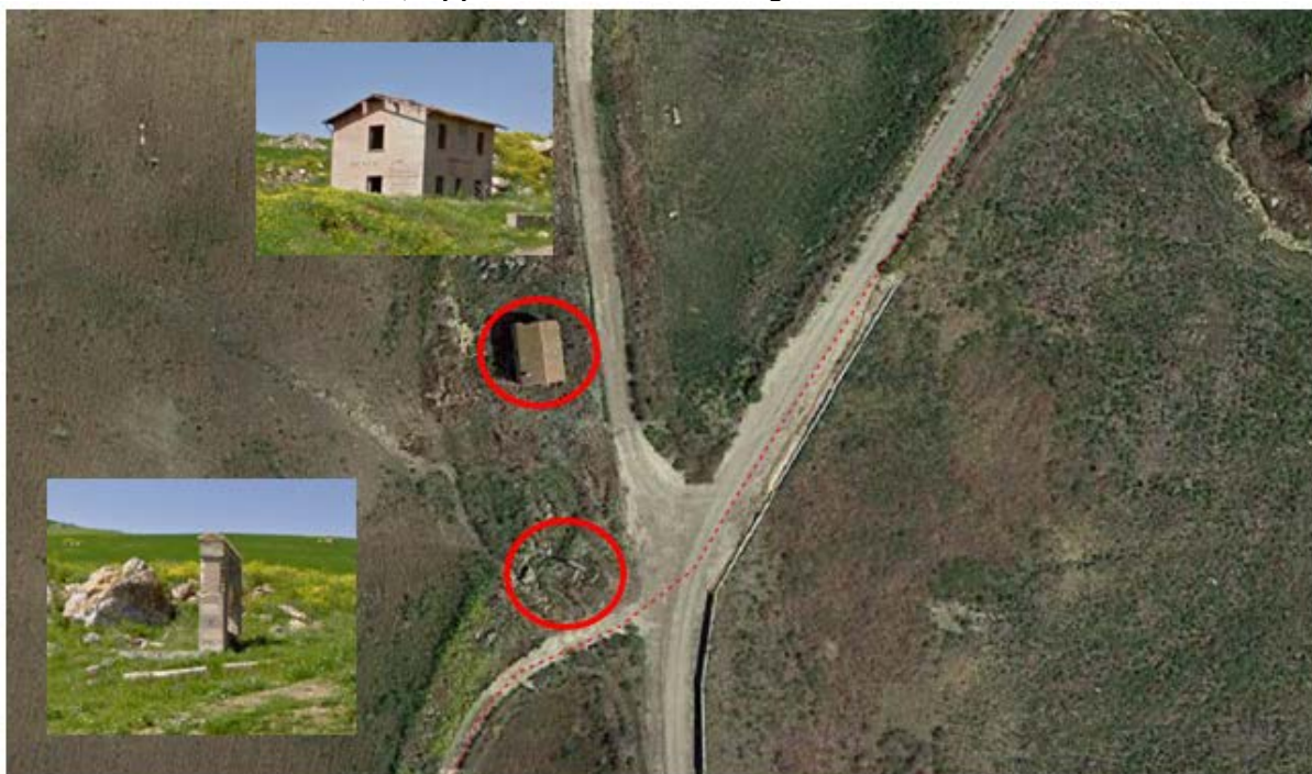
Figura 36: all'incrocio fra la SP 179 e la SP 182 sono collocati due beni censiti come beni isolati e in particolare 3. Abbeveratoio collocato a circa 10 metri dalla sezione di scavo del cavidotto; 4. Casa Cantoniera (Fg 16 Plla 246) collocata a circa 30 metri dalla sezione di scavo del cavidotto. Considerando una sezione di scavo di circa 0,6 m di larghezza ne deriva che il cavidotto non incide sul bene isolato.
