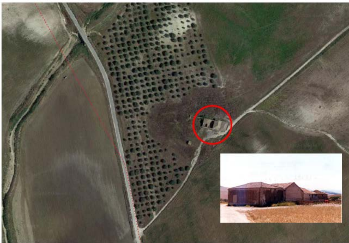
Figura 37: presso SP 182 si segnala la presenza di Masseria Giumenta (D1) in contrada Giumenta nel territorio comunale di Ramacca al Fg 16 Plla 246. Questa si colloca a circa 130 metri dalla sezione di scavo del cavidotto. Considerando una sezione di scavo di circa 0,6 m di larghezza ne deriva che il cavidotto non incide sul bene isolato.
