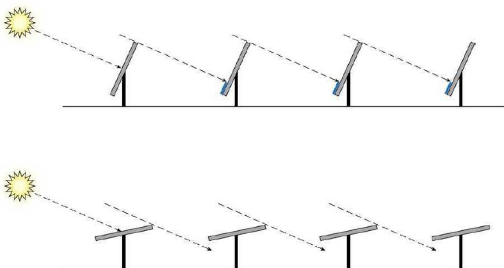
Figura 2: sistema di Backtracking
