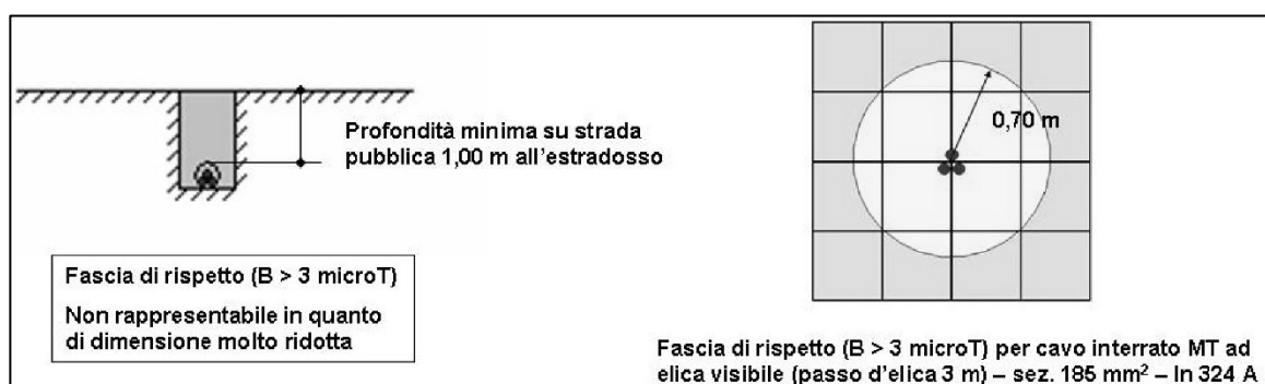
Estratto della guida di Enel sul calcolo della DPA: cavi in media tensione interrati
