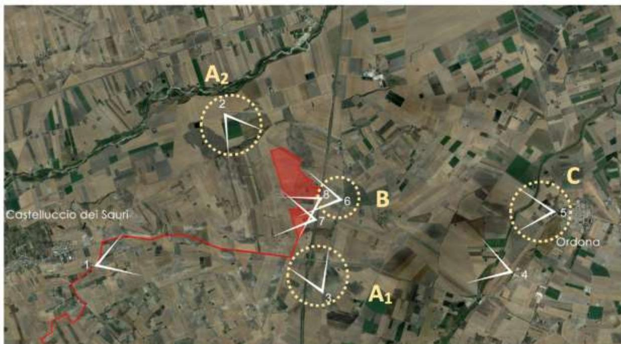
**Figura 1:** Coni visivi utilizzati per la valutazione della percezione paesaggistica e riferimenti ai punti di osservazione che rappresentano una specifica tipologia di percezione dell'impatto dell'impianto fotovoltaico da mitigare.
