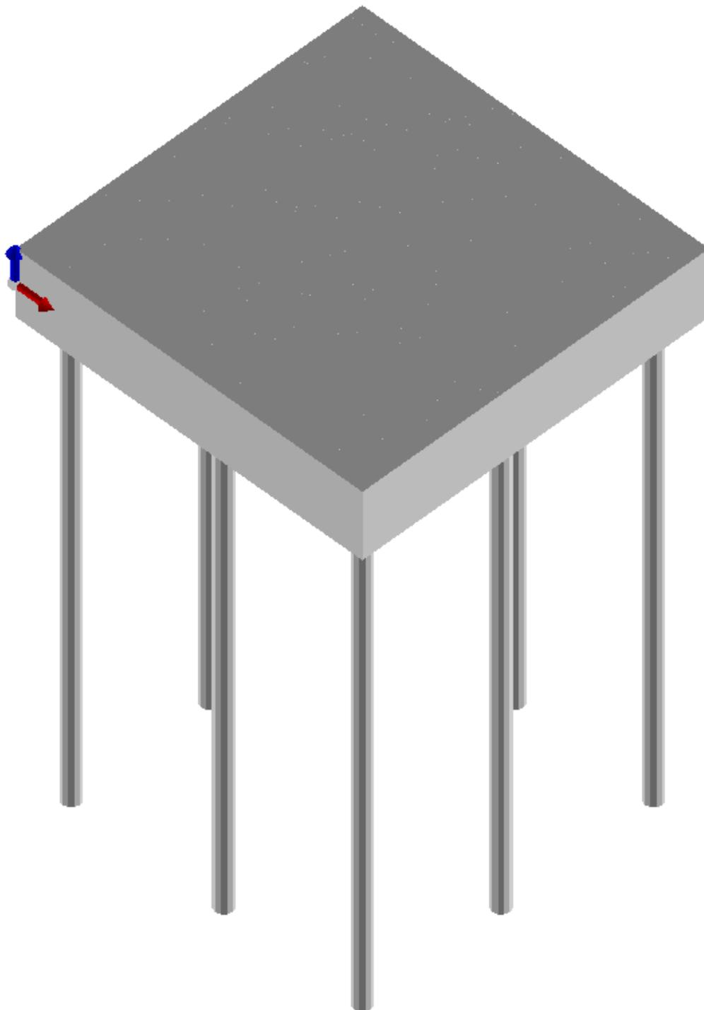
*Figura 2 – Modello solido platea con pali di fondazione*
