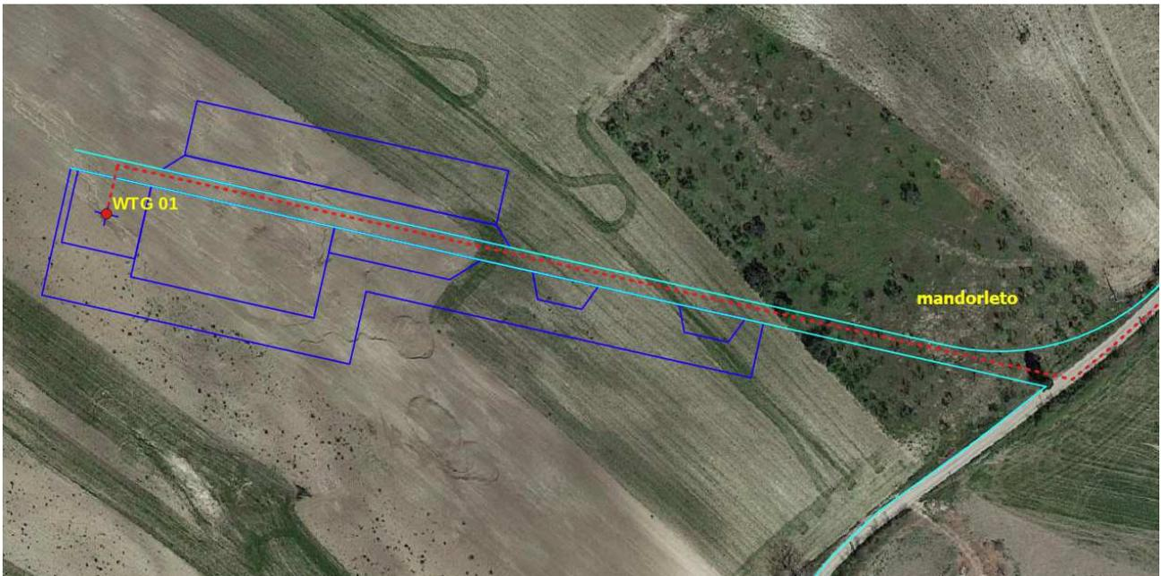
**Interferenza con un mandorleto dei tracciati della strada di accesso e del cavidotto interrato del wtg1**
