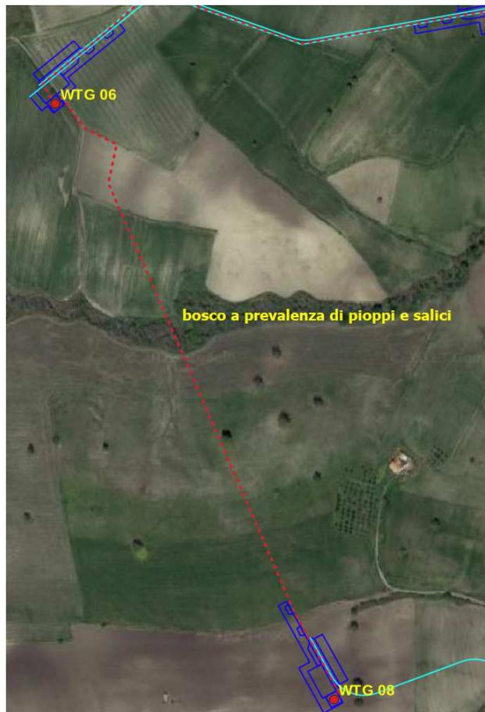
Interferenza con un bosco a prevalenza di pioppi e salici del tracciato del cavidotto interrato di collegamento tra wtg6 e wtg8
