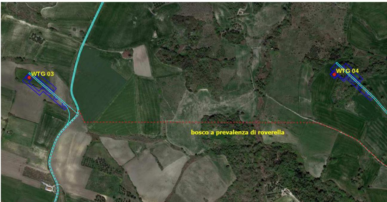
**Interferenza con un bosco a prevalenza di roverella del tracciato del cavidotto interrato di collegamento tra wtg3 e wtg4**
