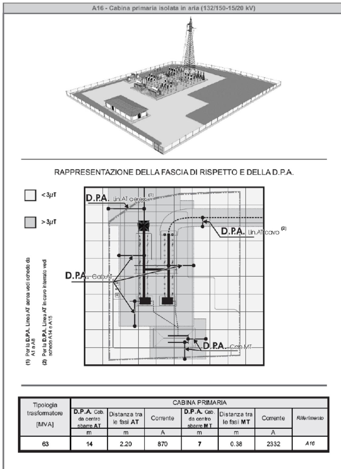
Figura 6 - Scheda A16 delle Linee Guida per l'applicazione dell'Allegato al DM 29.05.08 di Enel Distribuzione SpA
