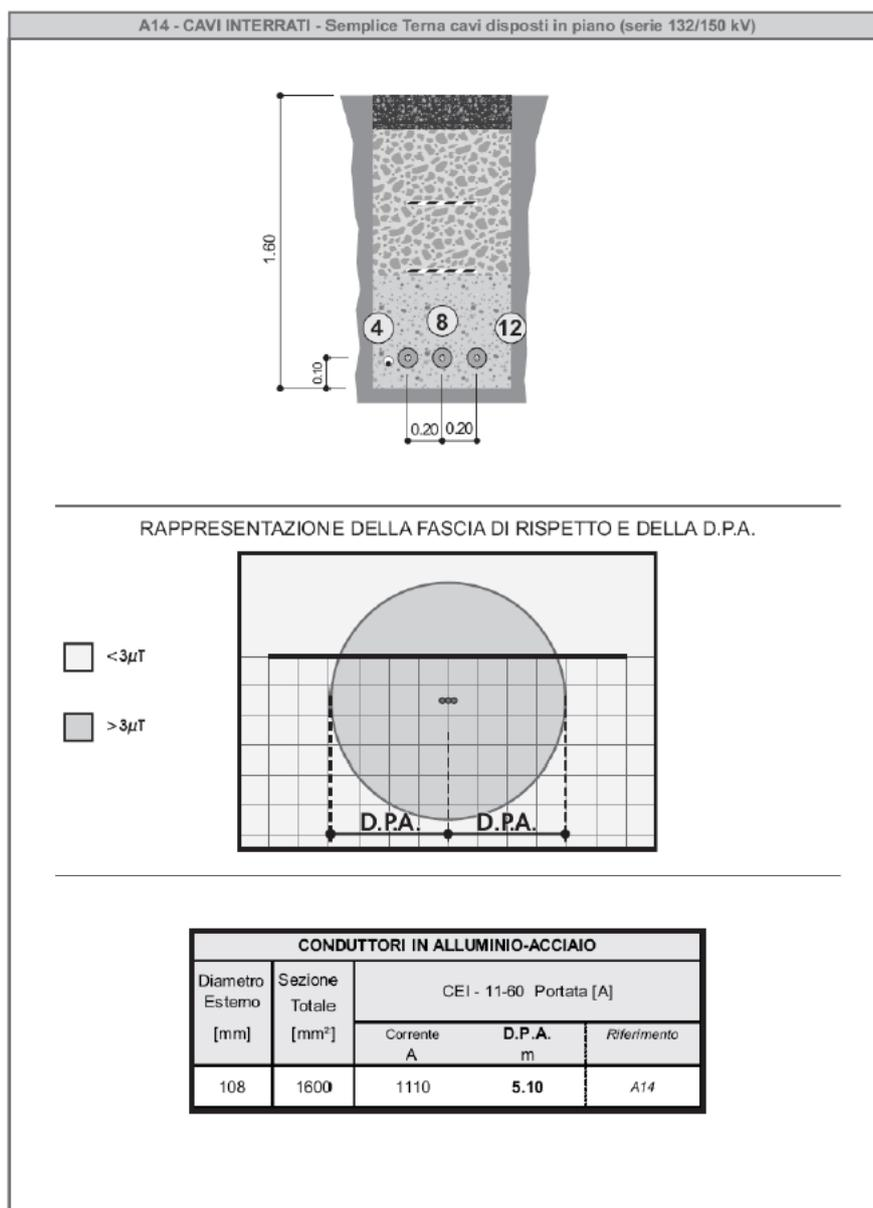
Figura 5 - Scheda A14 delle Linee Guida per l'applicazione dell'Allegato al DM 29.05.08 di Enel Distribuzione SpA
