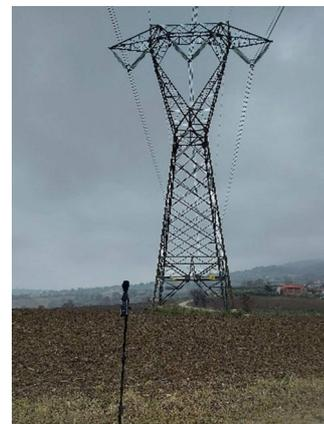
Figura 1 - Punto di misura test elettrodotto 380 kV "Larino - Gissi" vicino traliccio n 166
