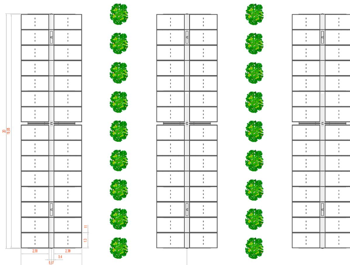
Figura 3.10: Dettaglio delle file dell'Oliveto tra le strutture dell'impianto fotovoltaico
