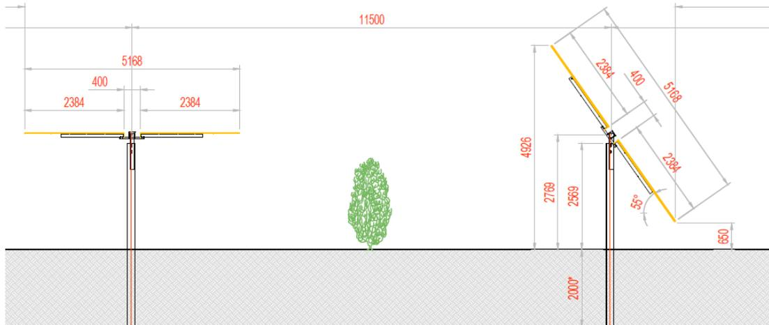
*Figura 3.2: Particolare strutture di sostegno moduli*
