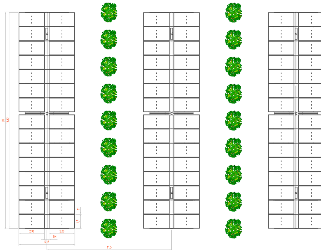
Figura 30. Dettaglio delle file dell'oliveto tra le strutture dell'impianto fotovoltaico
