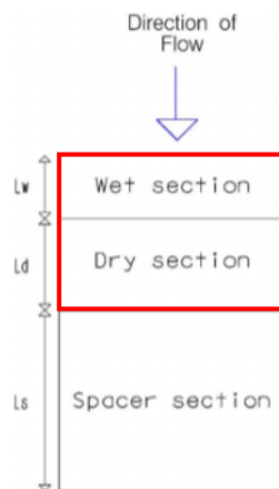
Figura 6.8: Modulo tipo, descrivente il modello concettuale idrologico dell'installazione di strutture fotovoltaiche a tracker su pali infissi comprendente l'area pannelli (in rosso) e l'area di interfila (Fonte: Hydrologic response of solar farm Cook 2013 American Society of Civil Engineers).
