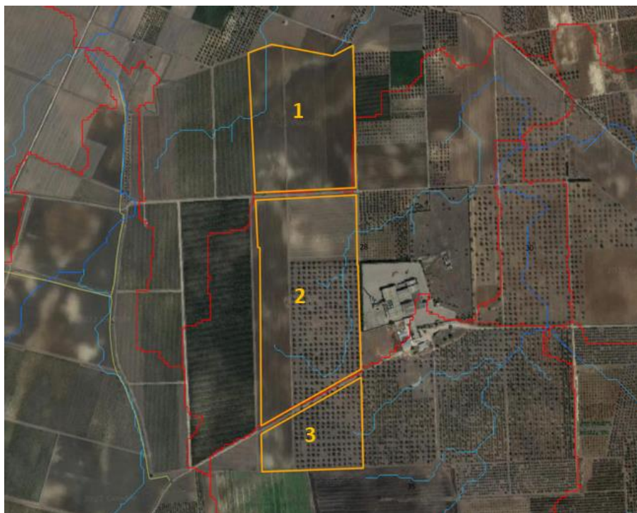
Figura 6.5: Delimitazione bacini scolanti e codifica (arancio), reticolo di drenaggio esterno ed interno alle sezioni di progetto (blu) e limiti bacini idrografici (rosso).
