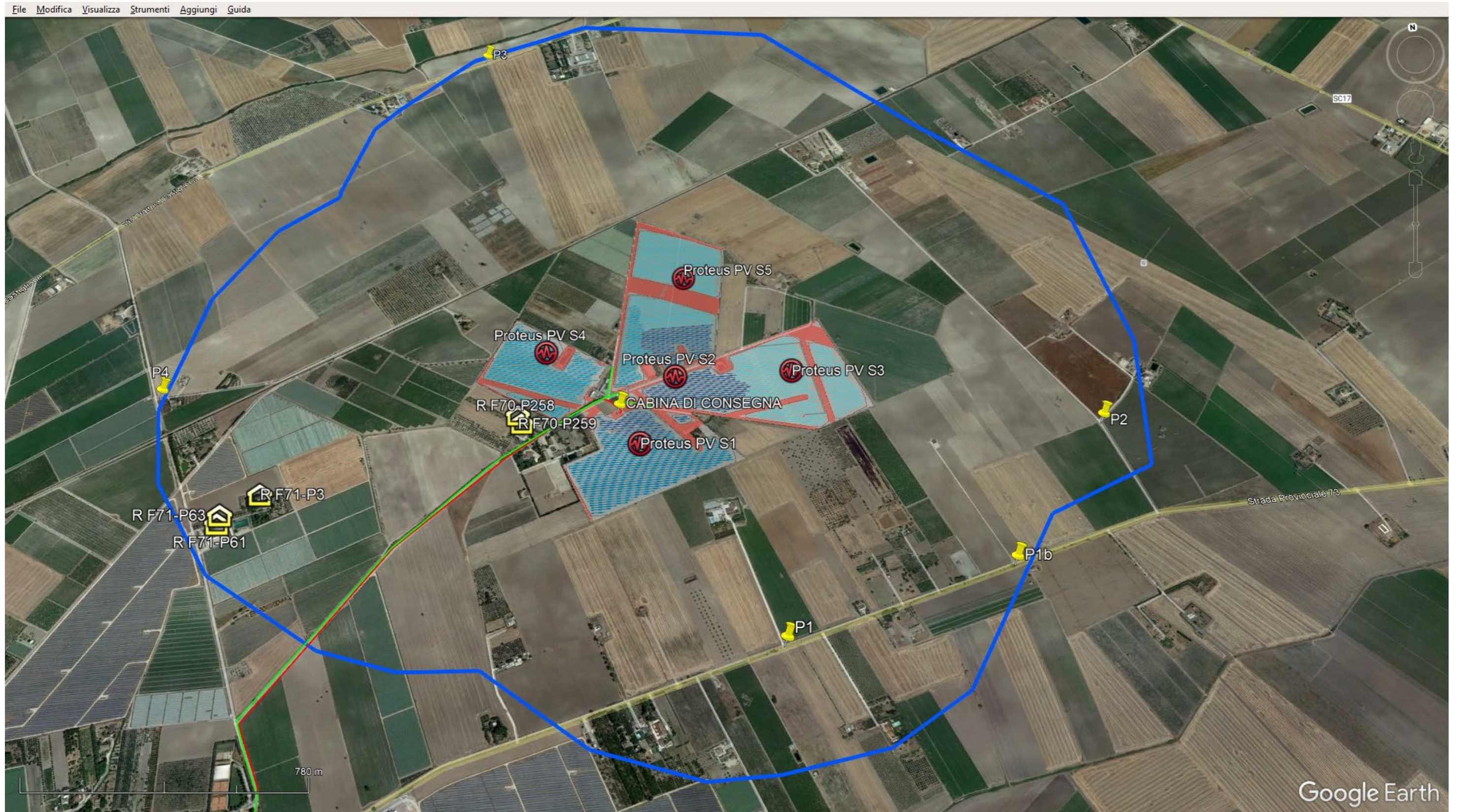
Tav.1.3 Area interessata e indicazione raggio 1000 metri dai vertici aree interessate e indicazione punto di misura(P); Ricettori (R ) e Trasformatori (PV)
