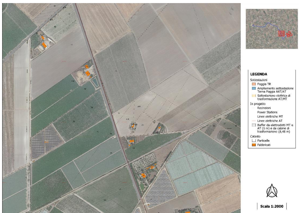
Figura 70: Planimetrie 4 su 10 su base ortofoto e catastale delle fasce di rispetto da considerare per le linee elettriche in media e alta tensione (1 m) e per le cabine di trasformazione (8,48 m) Scala 1:200.
