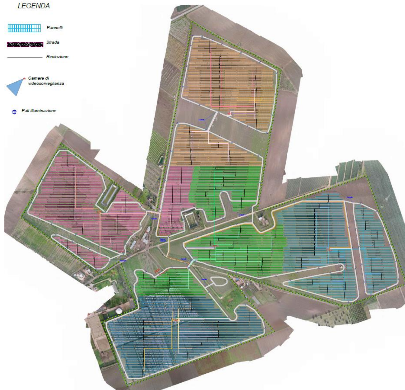
Figura 19 - Layout di impianto su ortofoto
