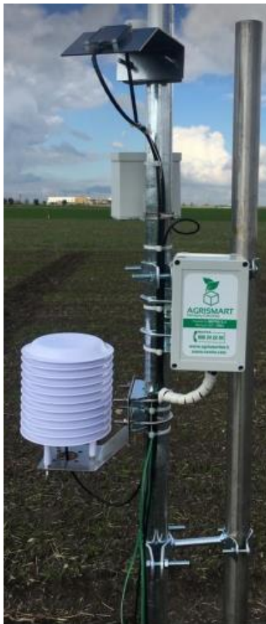
Figura 35 - Stazione meteo di tipo AGRISMART IOT
