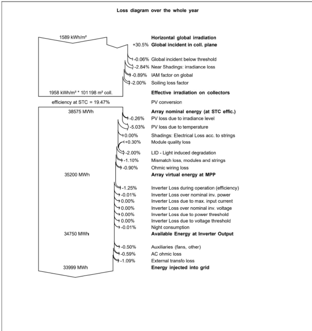
Si stima con l'ausilio del software certificato PV SYS come da report in allegato, per l'impianto di potenza totale pari a 36,7026 MWp una produzione di energia annua pari a **63.218,3563 MWh** (equivalente a **1 722 kWh/kW**)
