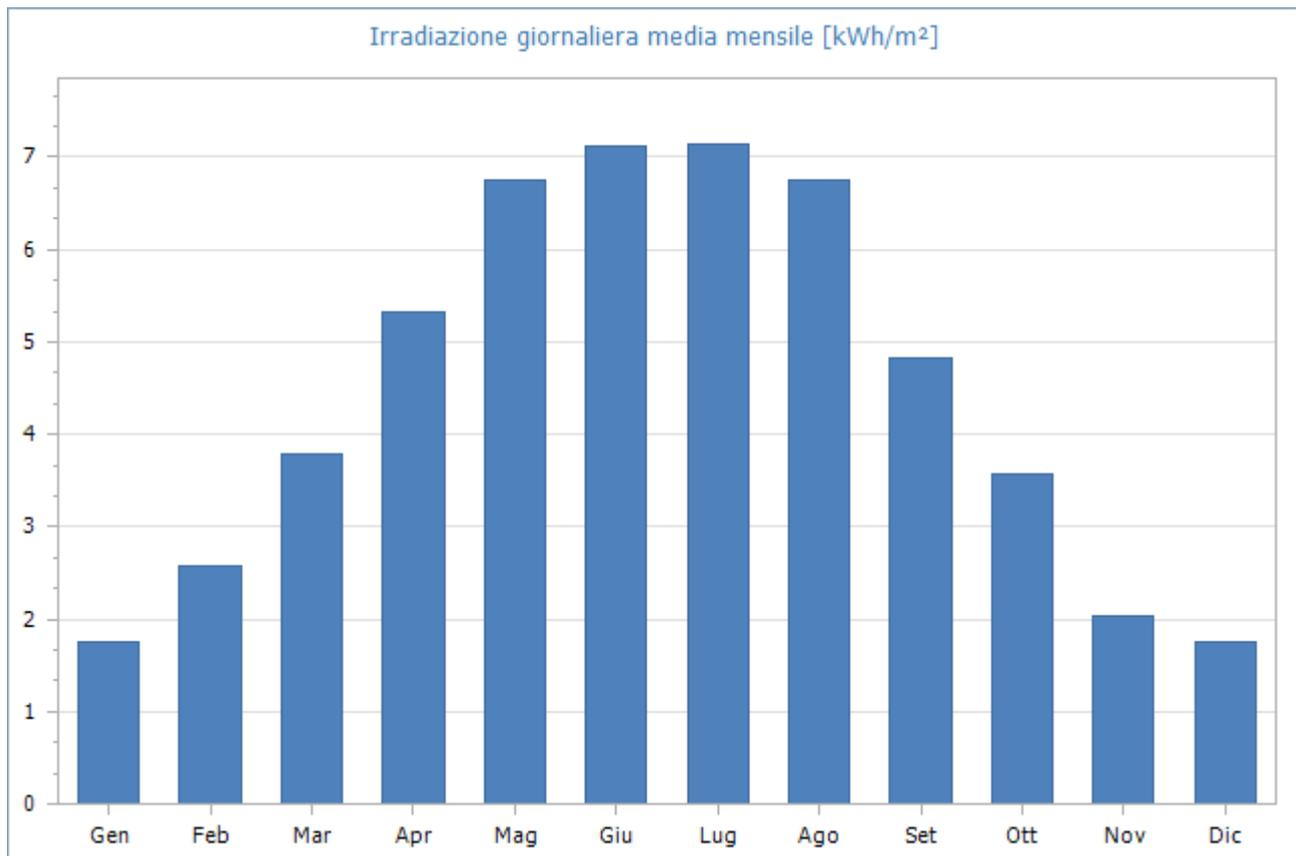
Fig. 1: Irradiazione giornaliera media mensile sul piano orizzontale [kWh/m²]- Fonte dati: UNI 10349:2016 - Stazione di rilevazione: Oppido Lucano
