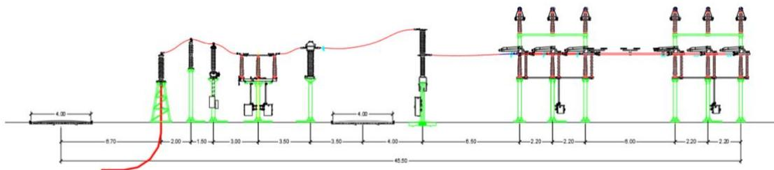
*Figura 2 – sezione futuro stallo 150 kV di arrivo in Stazione Elettrica RTN*
