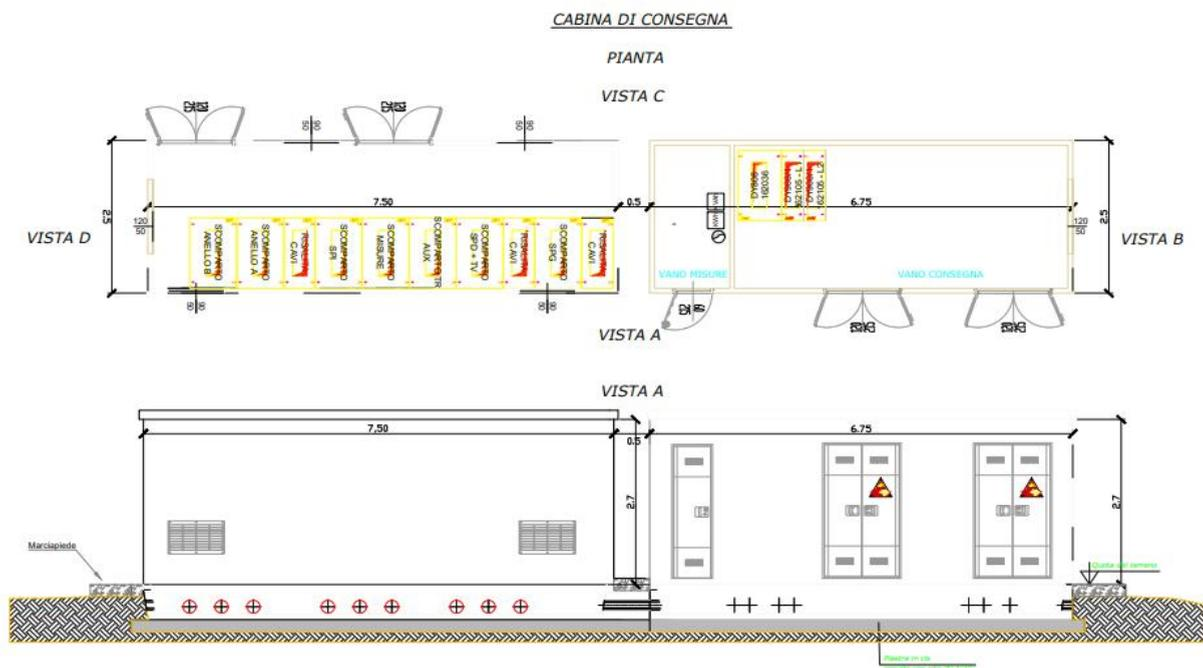
Scavo di sbancamento per posizionamento Cabina di Smistamento: 13.75 ml x 3.50 ml x 0.50 h.
