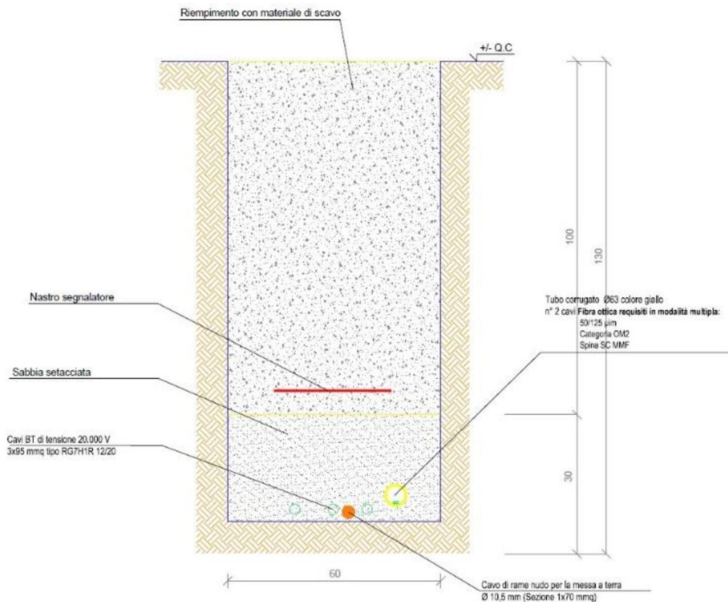
Scavo di sbancamento per posizionamento Cavidotto MT (interno ed esterno): 12'644 ml.
