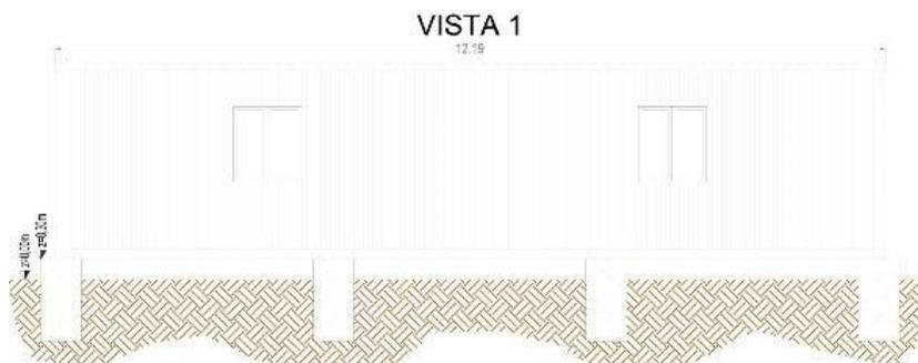
Scavo di sbancamento per posizionamento Container Magazzino: 5.30 ml x 13.30 ml x 0.50 h.
