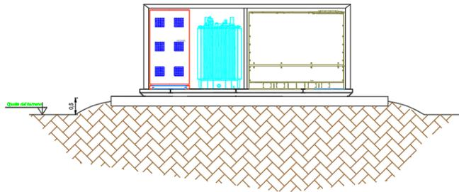
Scavo di sbancamento per posizionamento Cabina di Campo: 7 ml x 3.5 ml x 0.30 h.
