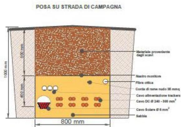
Fig. 16 – Particolare sezione tipo cavo interrato BT
