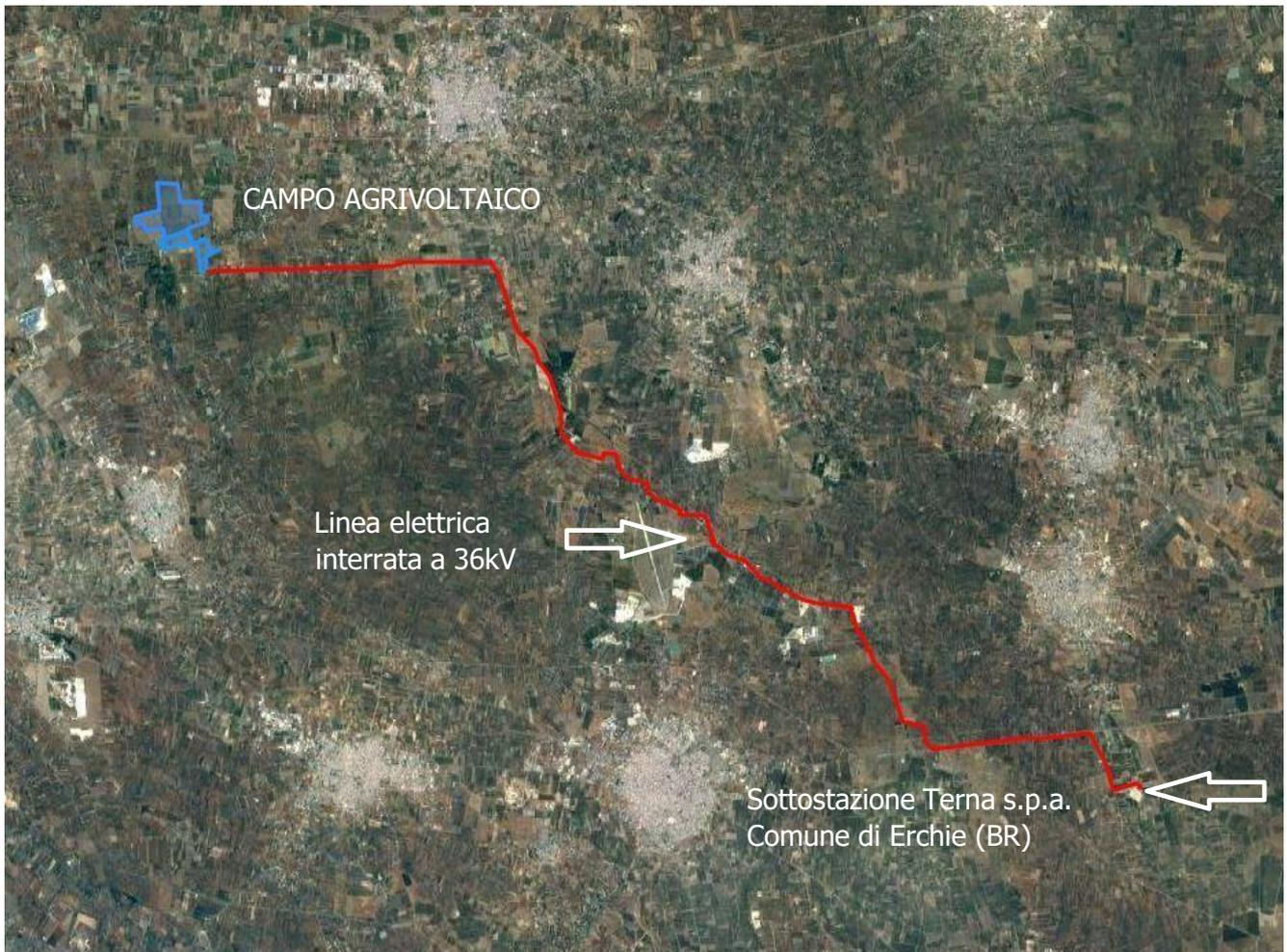
*Vista d'insieme dell'impianto con collegamento cavo a 36kV (in rosso)*
