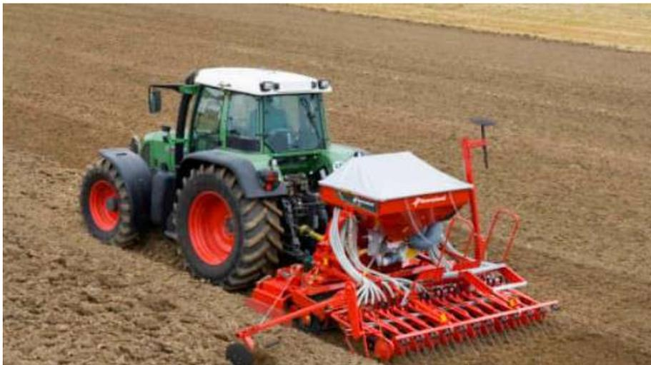
Figure 7-72. Esempio di seminatrice pneumatica per tutte le tipologie di sementi.
