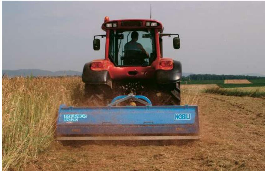
Figure 7-73. Esempio di trincia posteriore.
