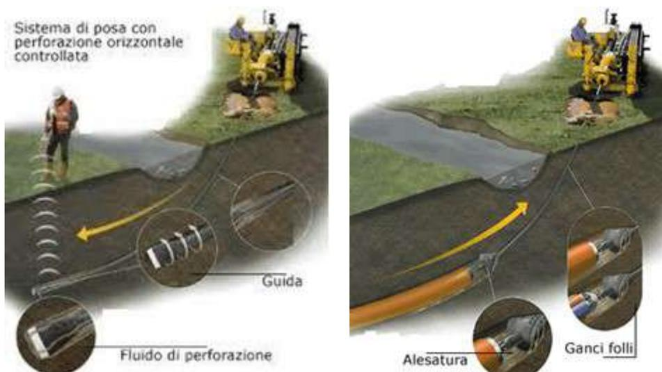
Uno dei tratti, lungo il percorso di connessione, in cui verrà realizzata la posa in opera del cavidotto interrato è quello relativo alla SS7ter, in cui mediante la tecnica di perforazione teleguidata "No dig" sarà possibile realizzare l'opera evitando problemi di interferenze con la viabilità.
