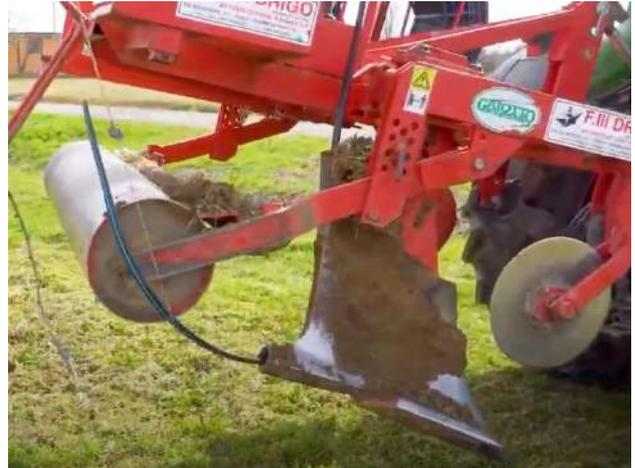
Figure 7-71. Posa ala gocciolante per impianto di sub-irrigazione.
