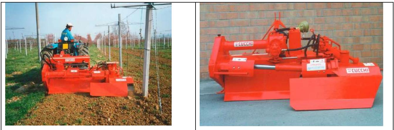
Figure 7-60. Esempio di fresatrice interceppo per le lavorazioni sulla fila
