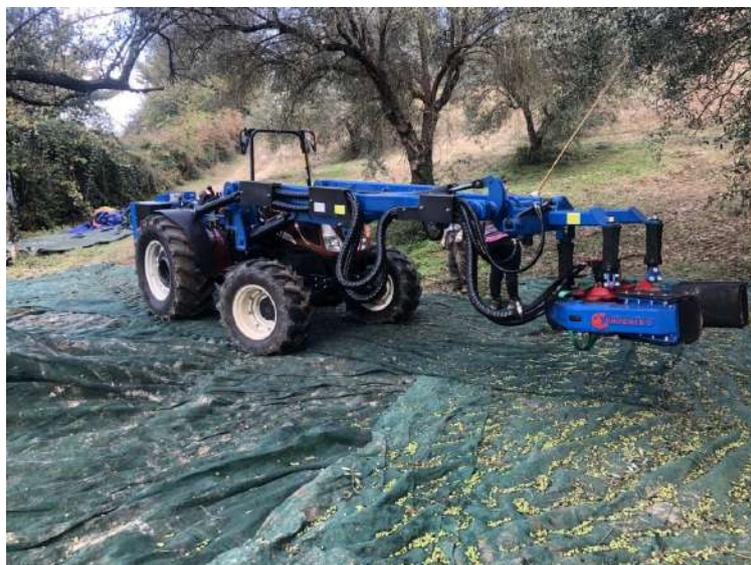
Figure 7-66. Macchina frontale per la raccolta delle olive su impianto intensivo
