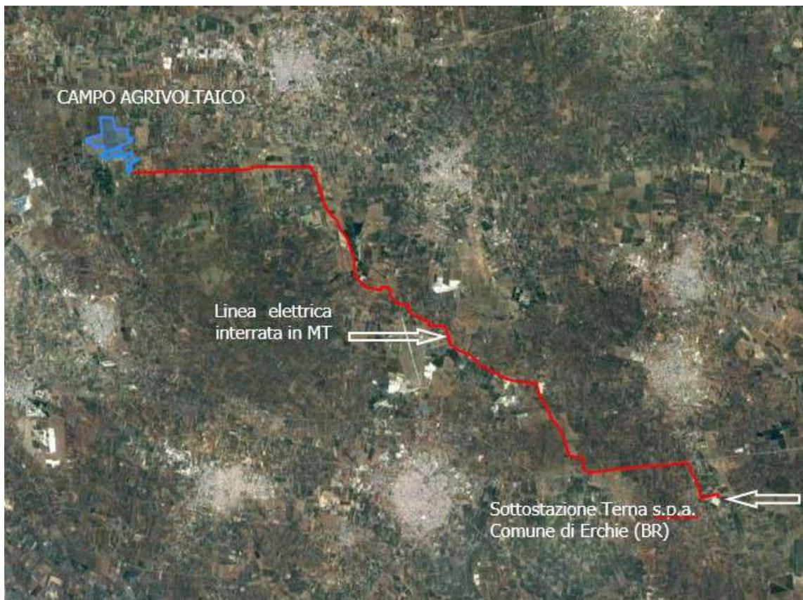
Figure 3-5. Vista d'insieme dell'impianto con collegamento elettrico (in blu)
