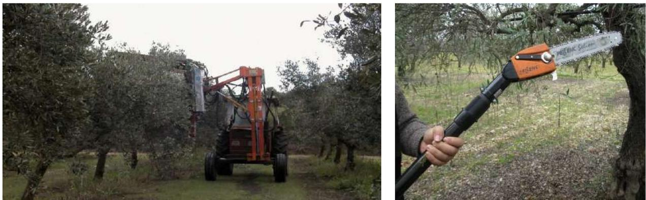
Figure 7-68. A sinistra\_ Esempio di potatrice meccanica frontale a doppia barra (taglio verticale + topping) utilizzabile su tutti le colture arboree intensive e superintensive; A destra\_ Attrezzatura manuale elettrica o a scoppio.
