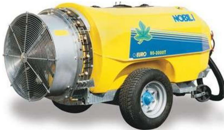
Figure 7-69. Esempi di turbo atomizzatore trainato per trattamenti del mandorleto.
