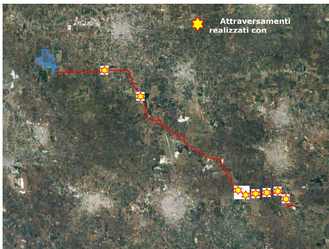
Figure 7-28. Planimetria degli attraversamenti con tecnica "No dig"
