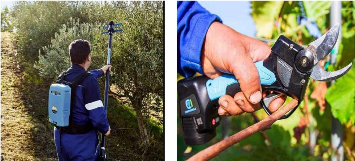
Figure 7-67. Forbici e abbacchiatori elettrici per agevolare i lavori manuali
