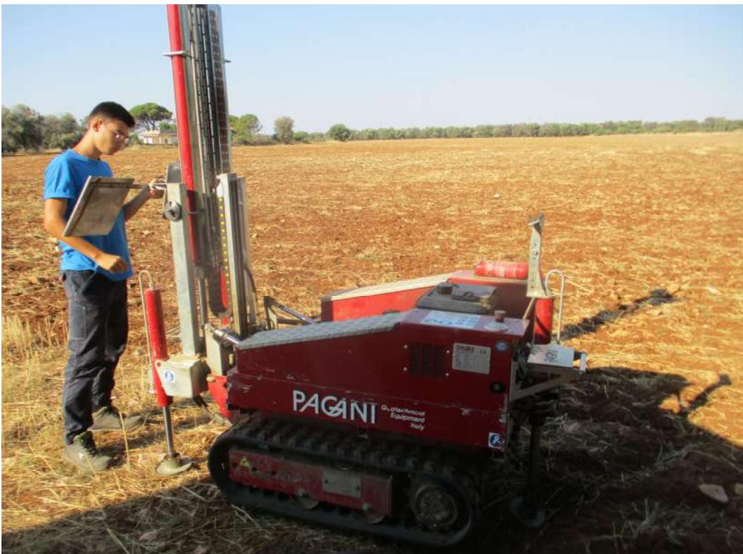
PROVA PENETROMETRICA DINAMICA Nr.2
