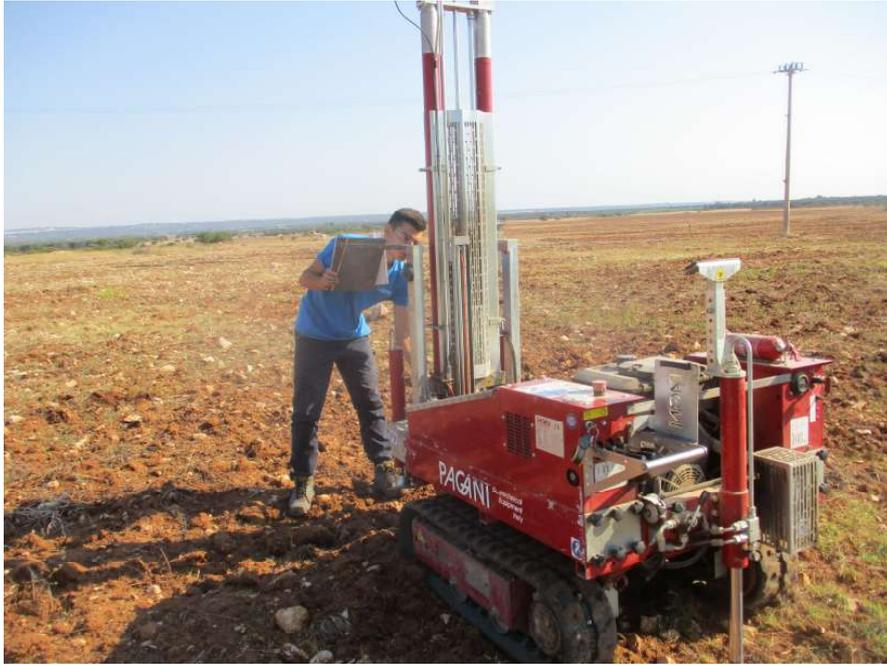
*Prova penetrometrica dinamica continua DPSH n.3*
