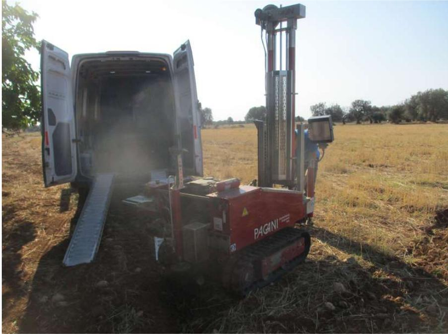
*Prova penetrometrica dinamica continua DPSH n.2*
