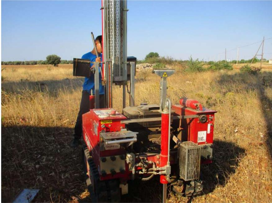
*Prova penetrometrica dinamica continua DPSH n.1*
