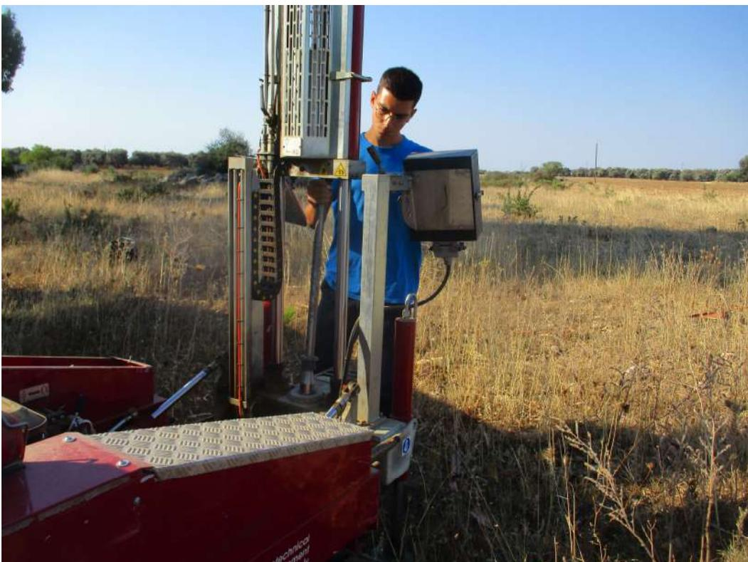
PROVA PENETROMETRICA DINAMICA Nr.1
