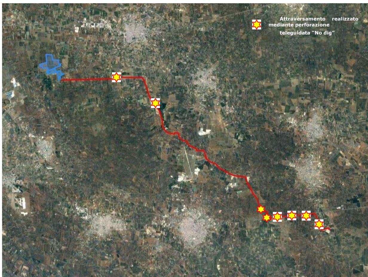
Figure 2-7. Planimetria d'insieme con interferenze
