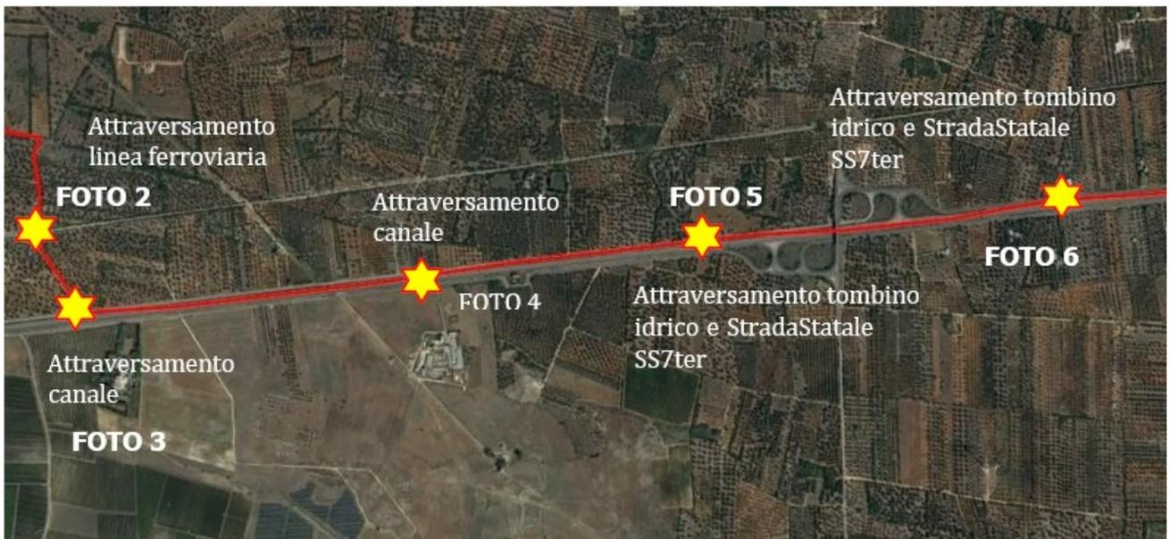
Figure 2-9. Planimetria di dettaglio n.2 con principali interferenze
