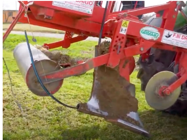
Figure 4-10. Posa ala gocciolante per impianto di sub-irrigazione.
