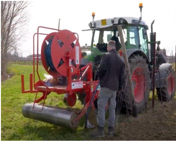
Figure 4-10. Posa ala gocciolante per impianto di sub-irrigazione.
