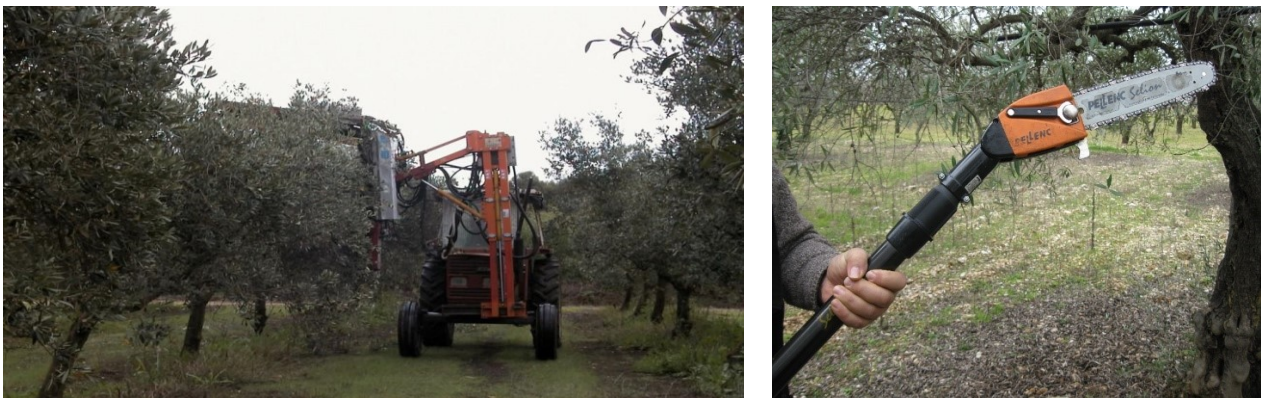
Figure 4-7. A sinistra_ Esempio di potatrice meccanica frontale a doppia barra (taglio verticale + topping) utilizzabile su tutti le colture arboree intensive e superintensive; A destra_ Attrezzatura manuale elettrica o a scoppio.
