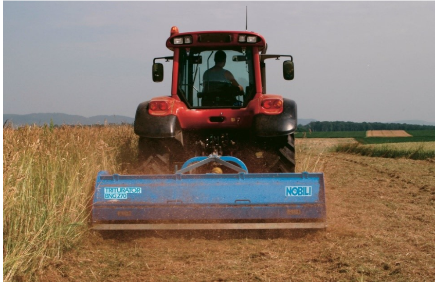
Figure 4-12. Esempio di trincia posteriore.
