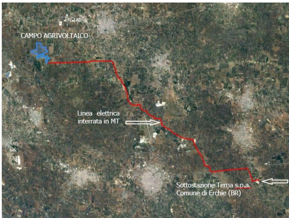
Figure 2-5. Vista d'insieme dell'impianto con collegamento elettrico di connessione alla SE (in blu)
