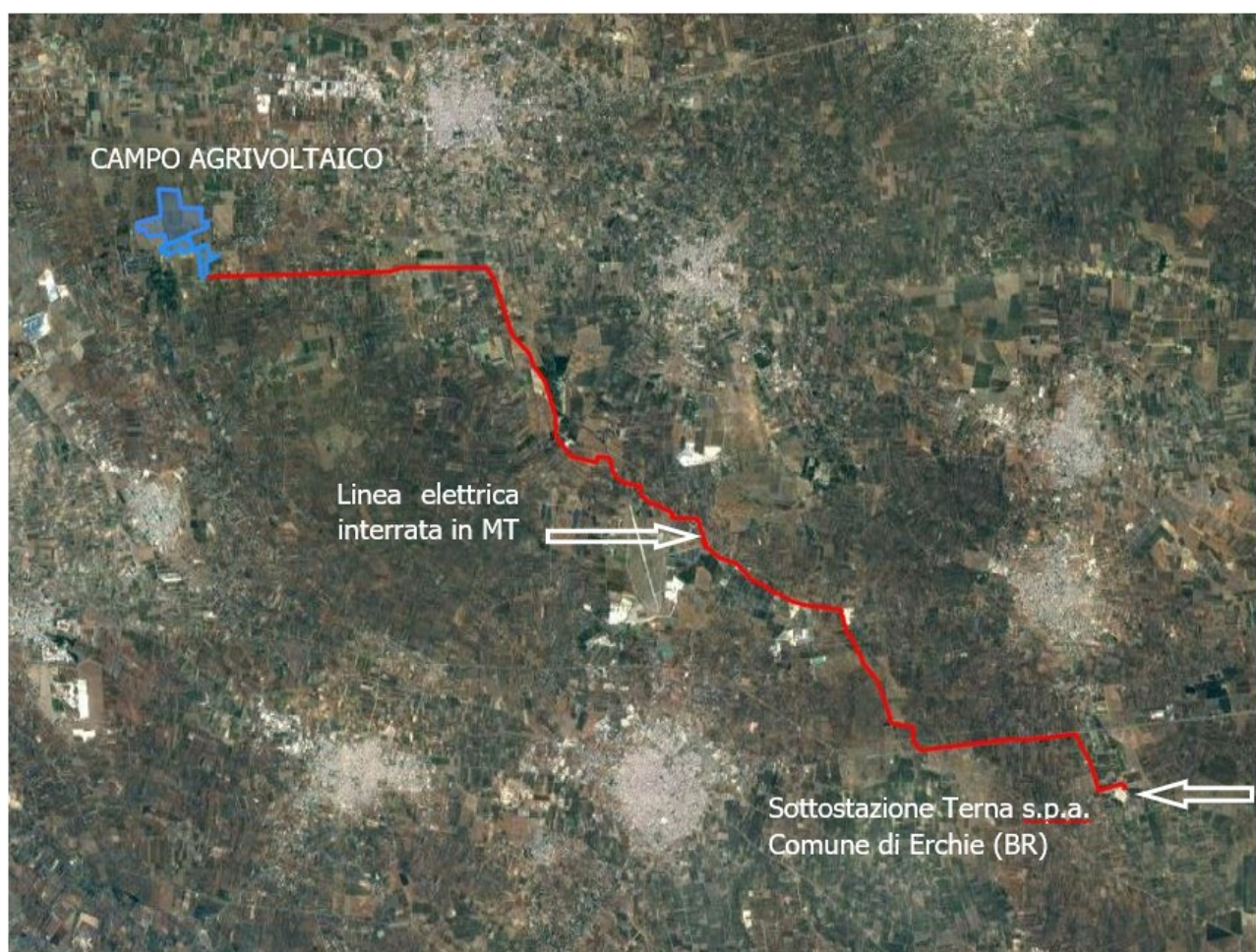
Figura 32: Vista d'insieme dell'impianto.
