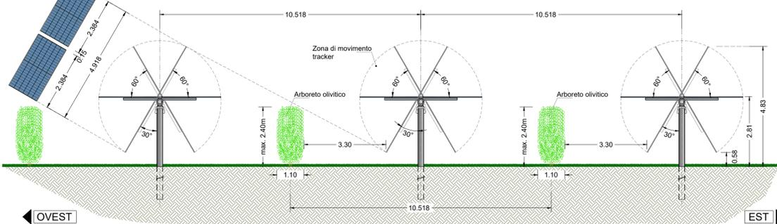
Schema di sezione tipo disposizione filari nella configurazione di manutenzione
