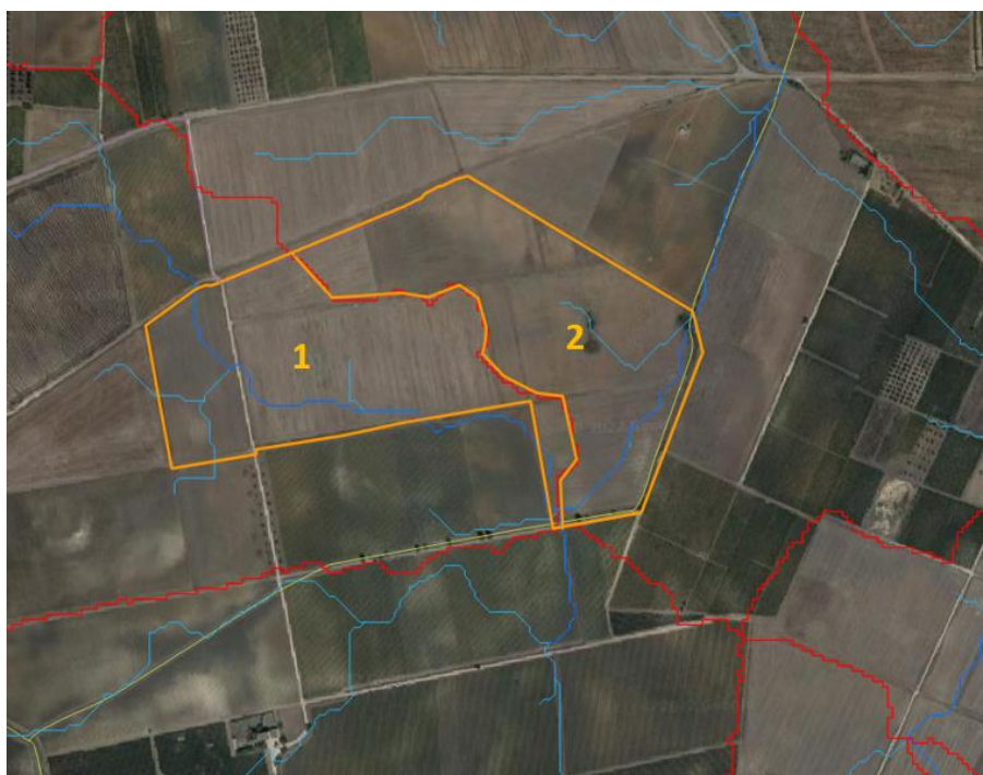
Figura 6.9: Delimitazione recinzione di impianto (arancio), rete di drenaggio naturale interna (blu) e spartiacque (rosso).
