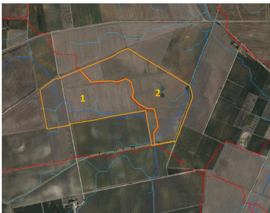
Figura 6.5: Delimitazione bacini scolanti e codifica (arancio), reticolo di drenaggio esterno ed interno alle sezioni di progetto (blu) e limiti bacini idrografici (rosso).
