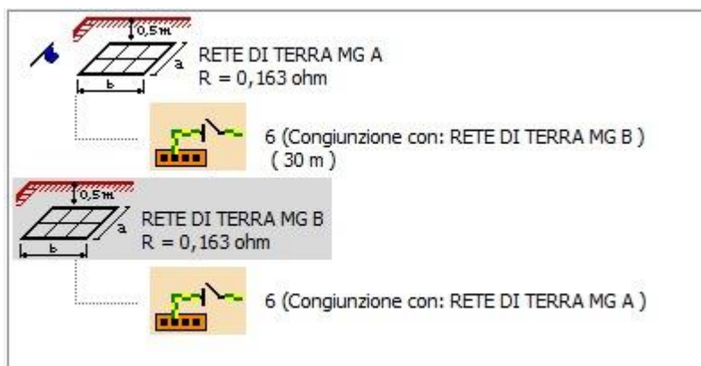
Figura 5.1.3: Calcolo resistenza di terra globale
