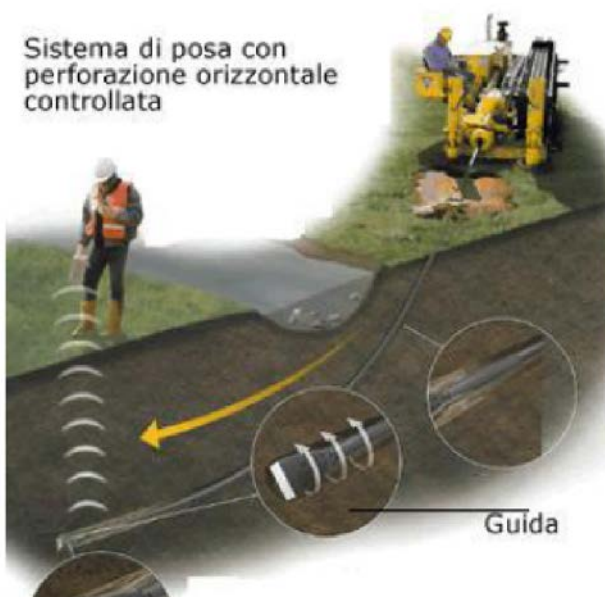
Sistema di trivellazione orizzontale controllata (T.O.C.)
