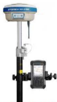
Ricevitore e controller Stonex S8 plus.
