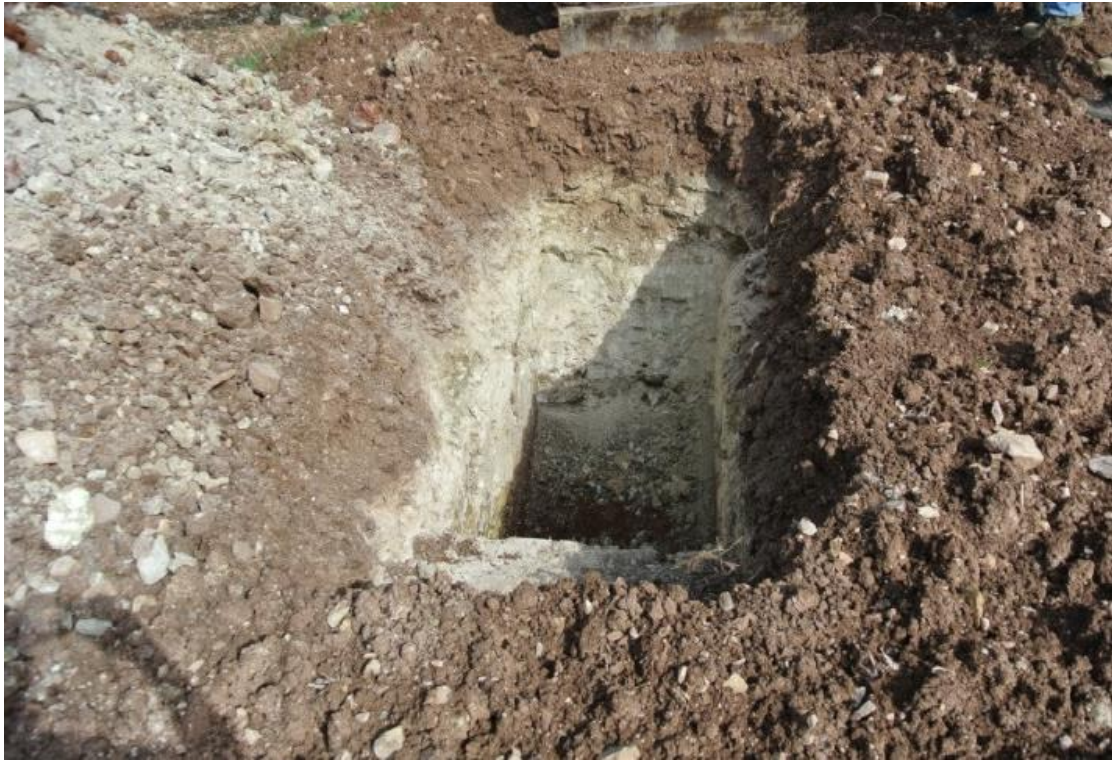
Figura 5 – Esempio campionamento terre: trincea di campionamento.
