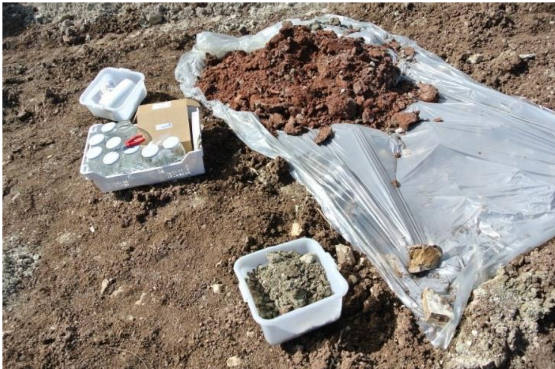
Figura 6 – Esempio campionamento terre: deposito materiale scavato.
