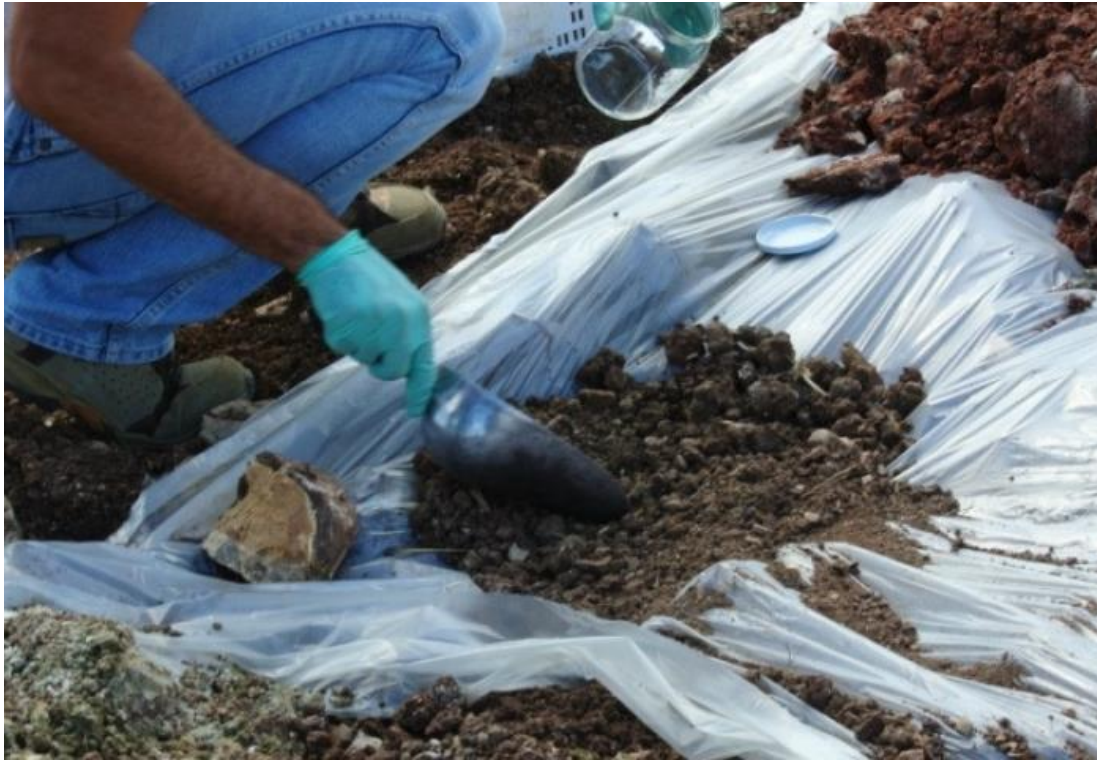
Figura 7 – Esempio campionamento terre: prelievo campioni.
