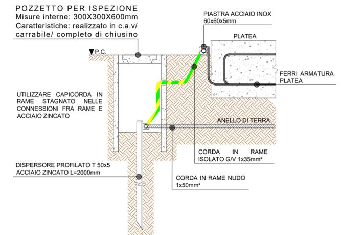
COLLEGAMENTO EQUIPOTENZIALE ARMATURA PLATEA - ANELLO DI TERRA | SCALA 1:16
