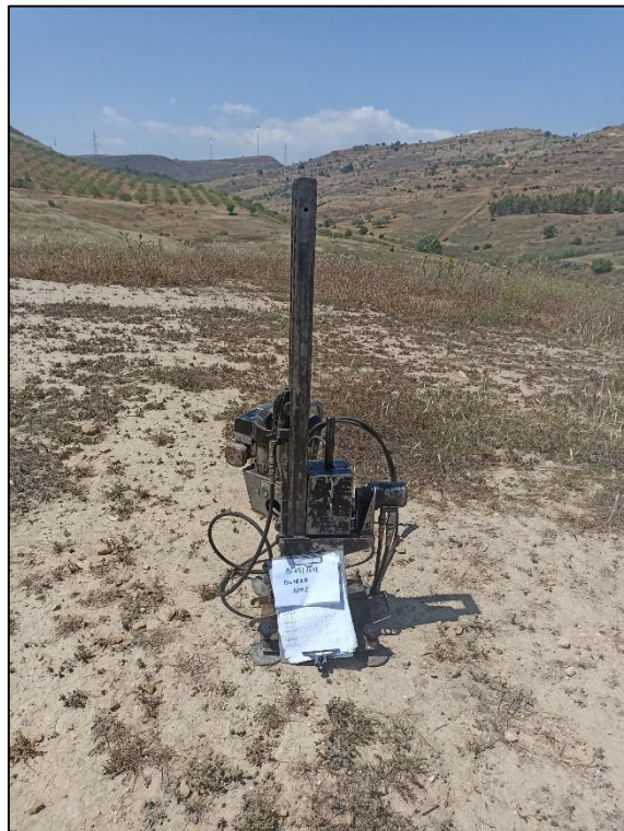
Fig_1-Postazione prova penetrometrica Din02
