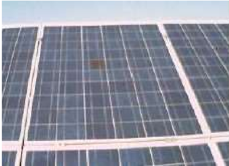
Figura 8.5 Pannello con hot spot
