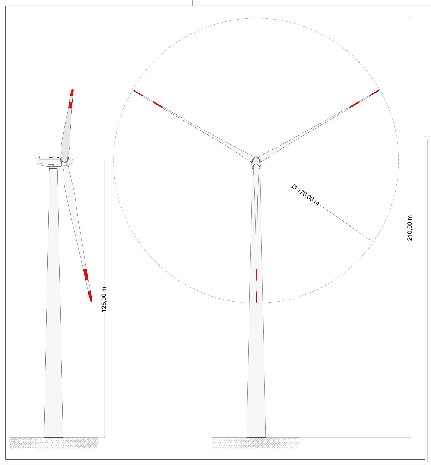
Potenza: 6.0 MW H al mozzo: 125,00 m H al tip: 210,00 m D rotore: 170,00 m
