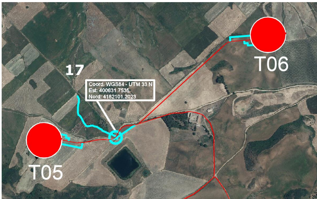
Figura 17 - Riquadro 4 di Figura 13 in cui è visibile l'attraversamento di corsi d'acqua in un punto (N°17).
