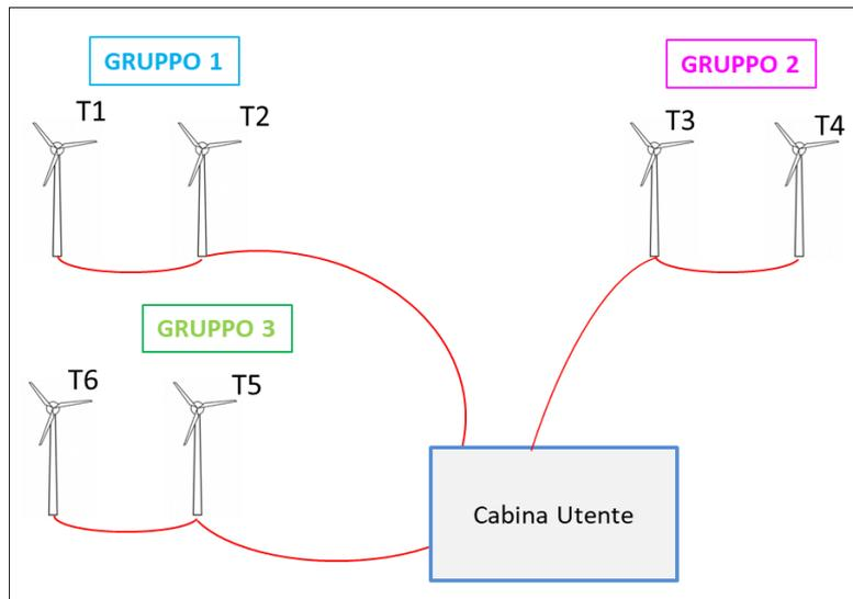
Figura 3: Schema circuitale di collegamento in MT del parco eolico alla SU
