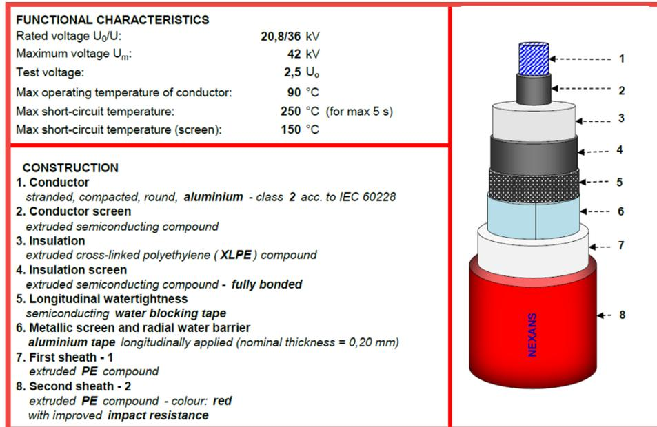
Figura 7: Caratteristiche tecniche del cavo in AT a 36 kV
